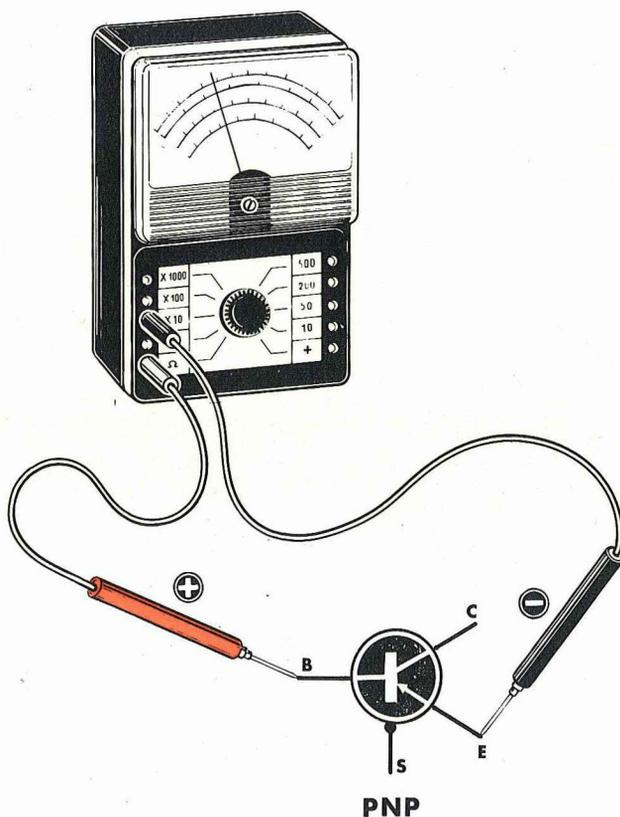
Fig. 17 Nei transistor a 4 terminali, cioè provvisti dello schermo, il puntale collegato alla base rispetterà le condizioni già precisate per i tipi PNP o NPN soltanto che in questo caso il valore ohmico tra B-C dovrà risultare sempre superiore a quello tra B-E.
