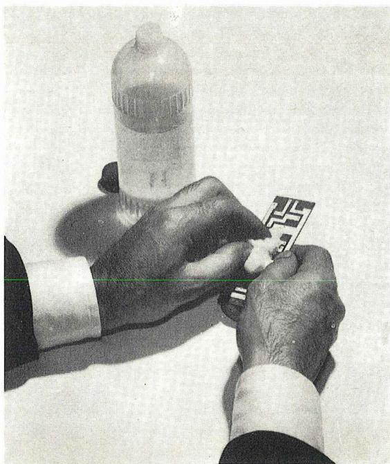
**Fig. 10** - Quando il circuito risulterà perfettamente inciso, per asportare l'inchiostro protettivo dalla superficie del rame, sarà sufficiente strofinare sopra ad esso un batuffolo di cotone imbevuto di normale alcool denaturato.
