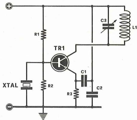
Fig. 16 oscillatore a quarzo per 27 MHz.
