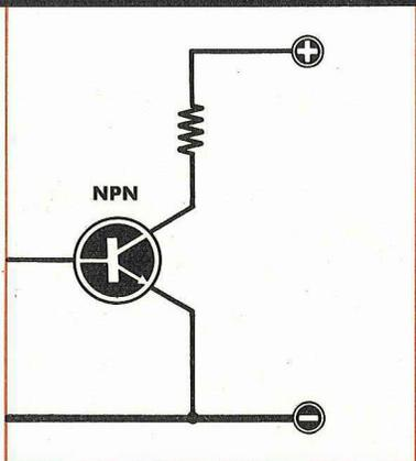
Fig. 7 Per i transistor appartenenti alla categoria NPN, sul collettore andrà applicato il positivo di alimentazione e sull'emettitore il negativo.
