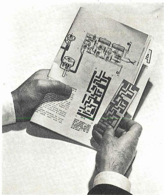
**Fig. 11** - Se avrete eseguito i contorni in modo perfetto, operazione questa, che potete eseguire con un tiralinee o pennino da normografo, ad incisione terminata, il circuito risulterà una copia fedele del disegno riportato sulla rivista.
