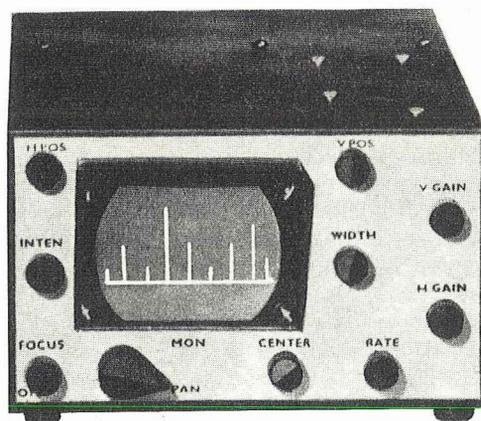
**Per i radioamatori piú esperti che desiderano completare la loro stazione con una strumentazione utile ad agevolare i loro QSO, consigliamo la realizzazione di questo ricevitore panoramico. Tale articolo vi potrà inoltre servire, svelandovi il principio di funzionamento, per progettare analoghi ricevitori piú o meno complessi di vostra ideazione.**
