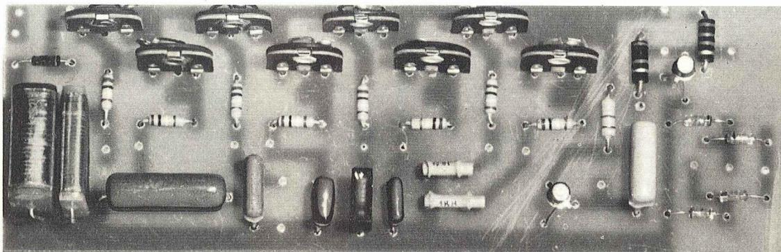
andrete ad inserirli nel circuito stampato perché se essi risulteranno collegati in maniera inversa a quanto richiesto dal circuito lo strumento ovviamente non potrà funzionare.
