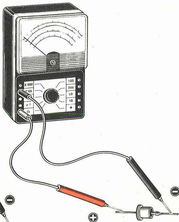
**Fig. 4** Sarà utile effettuare con i diodi anche la controprova, cioè invertire i puntali in modo da controllare se la lancetta rimanga sullo zero. Se notassimo che anche in tale condizione la lancetta si portasse a fondo scala potremo dedurre che il diodo è in cortocircuito, mentre se in nessuna delle due posizioni avessimo un'indicazione è evidente che il diodo è interrotto.
