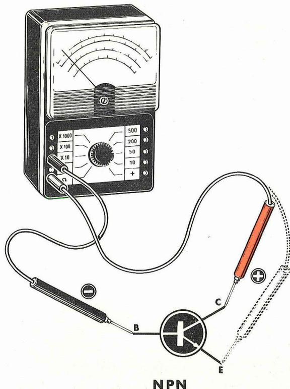
Fig. 14 Se il transistor è NPN sulla base applicheremo invece il puntale NEGATIVO. L'ohmetro dovrà sempre risultare nella posizione X1000. Se il transistor è efficiente dovremo rilevare tra le giunzioni B-C e B-E valori sempre superiori ai 200.000 ohm. Sarà utile effettuare sempre una controprova invertendo la polarità del puntale applicato alla base, ottenendo in questi casi, la condizione indicata in fig. 10.
