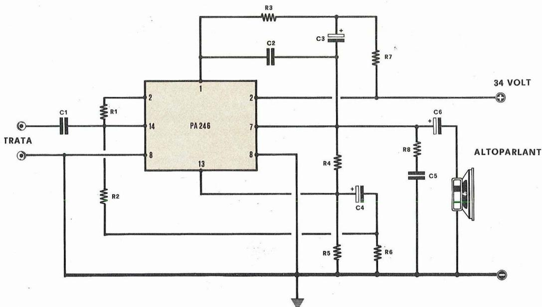
Fig. 5 - Se desiderate che un capo dell'altoparlante risulti collegato alla massa è necessario modificare il circuito presentato precedentemente con il presente.
