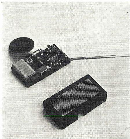
**Un economico ricetrasmittitore che un nostro collaboratore ha realizzato con ottimi risultati. La portata di questo apparecchio completamente transistorizzato si aggira sui 2 chilometri.**
