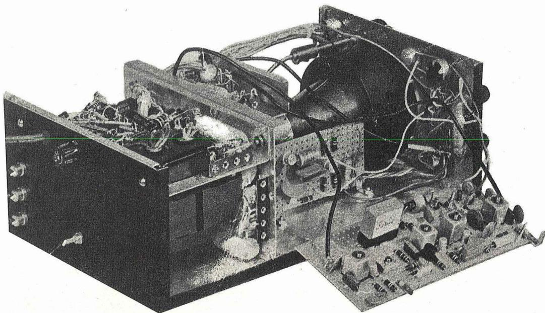
**Fig. 2 - Nella foto l'interno del ricevitore panoramico descritto nell'articolo. E' visibile a destra in basso, il telaio di media frequenza, e verticalmente vicino al tubo a raggi catodici il telaio oscillatore di BF per il pilotaggio del diodo varicap.**
