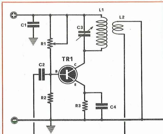
**Fig. 3** oscillatore VFO con accordo di COLLETTORE
