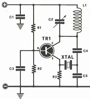
Fig. 17 oscillatore a quarzo per 7 MHz.
