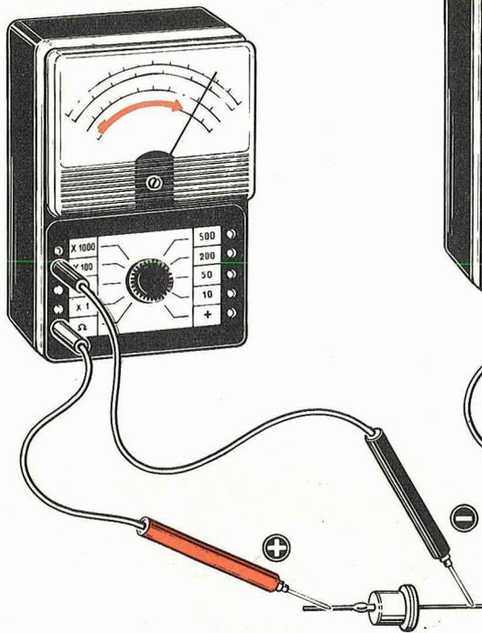
**Fig. 3** Conoscendo quale polarità è presente sui puntali nella portata ohmica del vostro tester sarete in grado anche di individuare il CATODO e l'ANODO di qualsiasi diodo sconosciuto. Se ad esempio la lancetta dello strumento, in posizione X100, andrà a fondo scala il CATODO del diodo è quello rivolto verso il puntale negativo.
