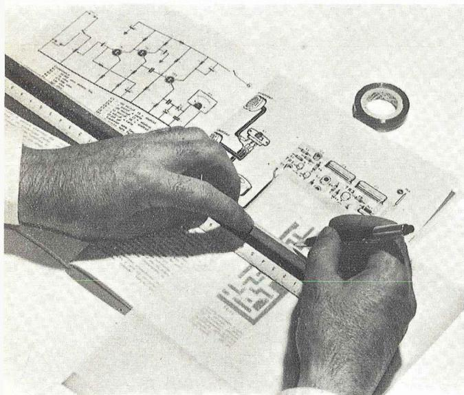
Fig. 1 - Per riprendere il disegno di un circuito stampato da una rivista, è sufficiente appoggiare sopra ad esso un foglio di carta lucida ricopiando poi i contorni nel modo più preciso possibile con una biro o matita.
