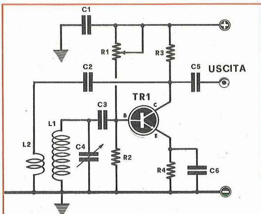
**Fig. 2** oscillatore VFO con accordo di BASE
