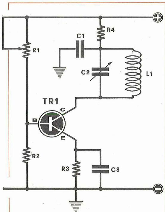
**Fig. 1** In un oscillatore di AF, la bobina L1 ed il condensatore variabile C2 dovranno essere rapportati in funzione alla frequenza di emissione come dai dati indicati in tabella. Il trimmer R1, utile a ricercare il valore più idoneo di polarizzazione di base, in fase di progettazione, può essere sostituito in seguito con una resistenza fissa.
