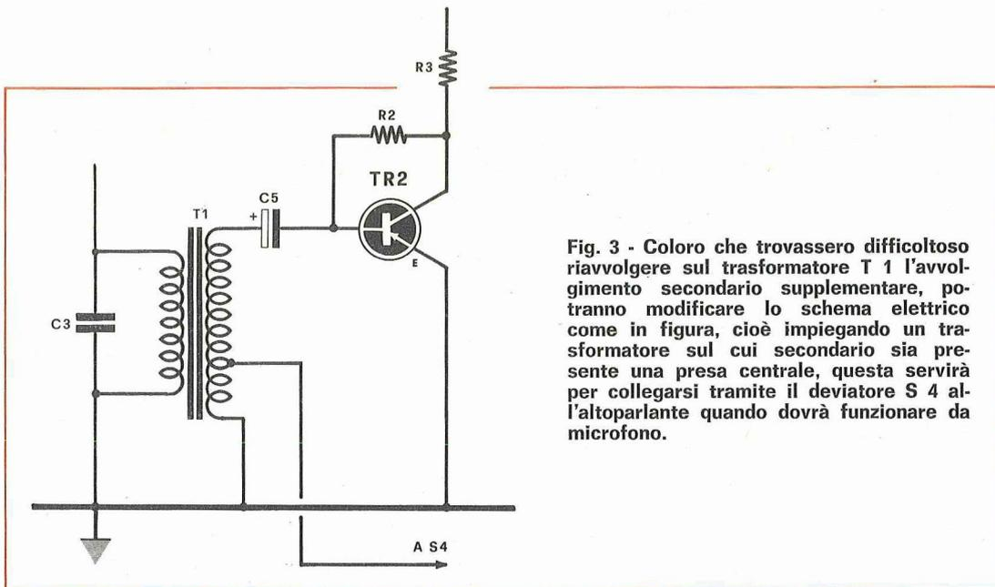
Fig. 3 - Coloro che trovassero difficoltoso riavvolgere sul trasformatore T 1 l'avvolgimento secondario supplementare, potranno modificare lo schema elettrico come in figura, cioè impiegando un trasformatore sul cui secondario sia presente una presa centrale, questa servirà per collegarsi tramite il deviatore S 4 all'altoparlante quando dovrà funzionare da microfono.
