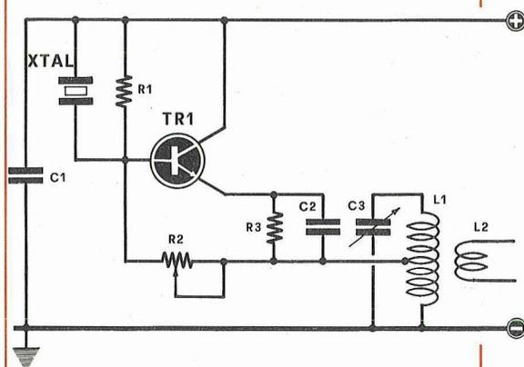
Fig. 19 oscillatore a quarzo accordato in emettitore
