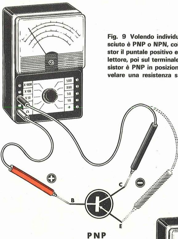
**Fig. 9** Volendo individuare se il transistor sconosciuto è PNP o NPN, collegate alla base del transistor il puntale positivo ed il negativo prima sul collettore, poi sul terminale dell'emettitore. Se il transistor è PNP in posizione OHM - X10 dovremo rivelare una resistenza superiore ai 200.000 ohm.
