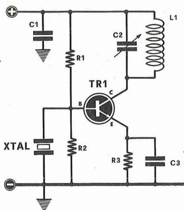
Fig. 18 oscillatore a quarzo per 27 MHz.
