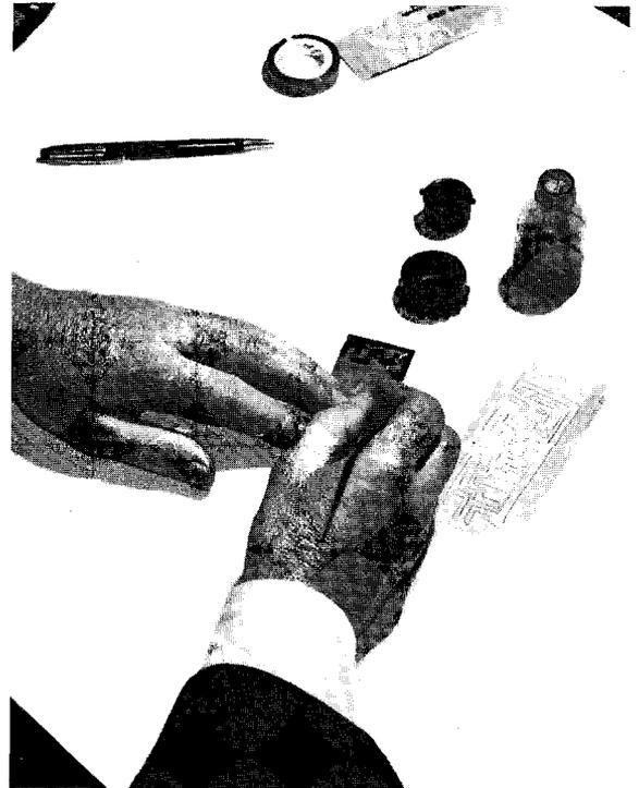
**Fig. 6 - Terminata l'operazione di ricalco, sul rame risulterà riportato dalla carta carbone il disegno del vostro circuito. La superficie di rame che vogliamo rimanga sulla basetta andrà ora ricoperta con l'apposito inchiostro protettivo.**
